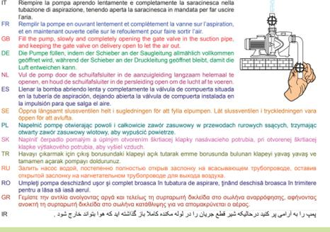
IT Ripre la pompa aprendo lentamente e completamente la saracinesca nella tubazione di aspirazione, tenendo aperta la saracinesca in mandata per isolare l'aria.
